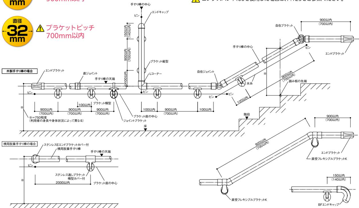
※転倒・転落を防ぐため、階段などの段差付近や足元が滑りやすい場所では、必ず手すりを連続させてください。(単位:mm) ( )内はφ32を示す。
